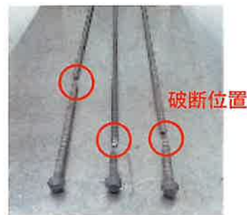
試験片の破断状況
