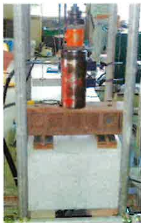
定着性能を確認する引抜き試験 （定着試験）
