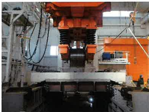
輪荷重載荷試験装置
