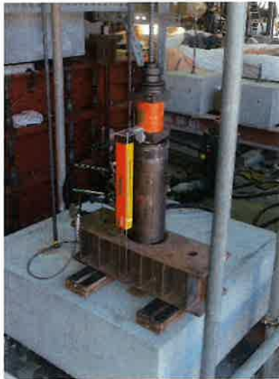
引抜き試験状況
